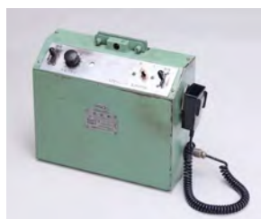
Photo.17 8000系車両の放送装置 東武博物館蔵 車内放送を行う機器
